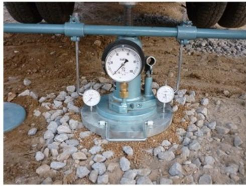
HySPEED工法の特徴は施工後　すぐに平板載荷試験を実施し性能検査試験を行い品質確認をします。数ある工法中でも平板載荷試験を行うのはHySPEED工法だけです。これも安心できる一つの理由です。
